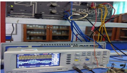
Gambar 8 Hasil Pengujian osilator pada AM dengan  $V_{in}=22$  V
